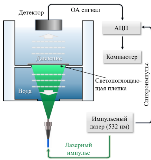
Рис. 1. Схема экспериментальной установки для измерения чувствительности пьезополимерных детекторов
