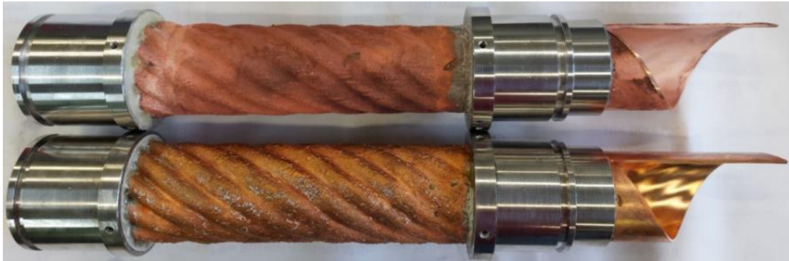
Рисунок 2.8 - Два образца синтезированного излучателя для 28 ГГц гиротрона, изготовленные путем трехмерной полимерной печати (верхний образец) и ЧПУ фрезерования (нижний)
