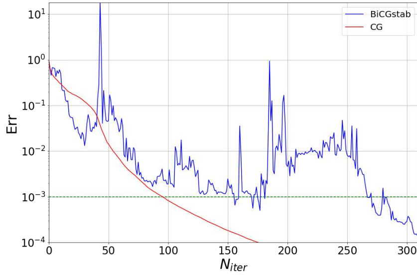
Рисунок 1.3 - Сравнение характеров сходимости методов CG и BiCGstab
